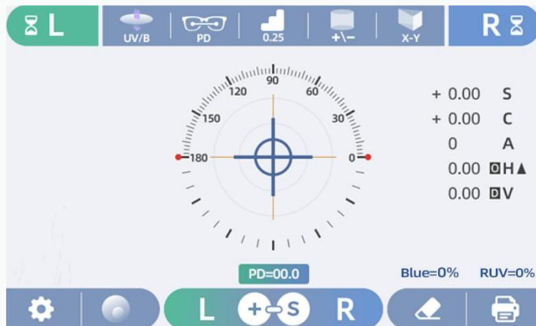
更换上左镜片，长按记忆键 2 到 3 秒，松开手后 UV/蓝光值将显示在屏幕的左下角；
