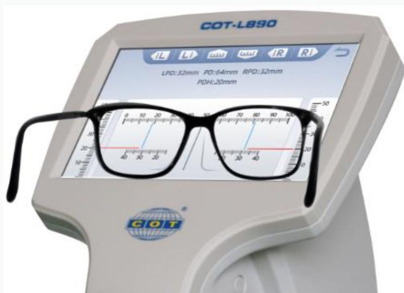
手持镜腿，将打好光学中心点的装成镜水平搁置在液晶屏外框底部平台上，鼻梁中心部位对准电子瞳距尺鼻梁中心标志线（请不要重压触摸屏），分别按压左、右眼瞳距移动按钮，控制光学中心标尺（左右眼各有一根蓝色垂直线条）左右移动，使蓝色垂直线条与镜片光学中心点重合，中心水平电子标尺蓝色垂直线条示值即为左右眼单瞳距及总瞳距，显示屏上亦可同时显示该数值；按压瞳高移动按钮，控制瞳高标尺（左右眼各有一根红色水平线条）上下移动，使红色水平线条与镜片光学中心点重合，左右两侧垂直电子标尺红色水平线条示值即为双眼瞳高，显示屏上亦可同时显示该数值。
