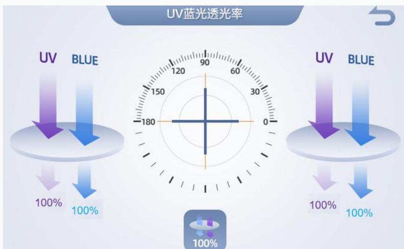
c: 放上镜片，移动至镜片中心，按
