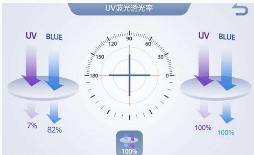
d: 更换镜片，按
